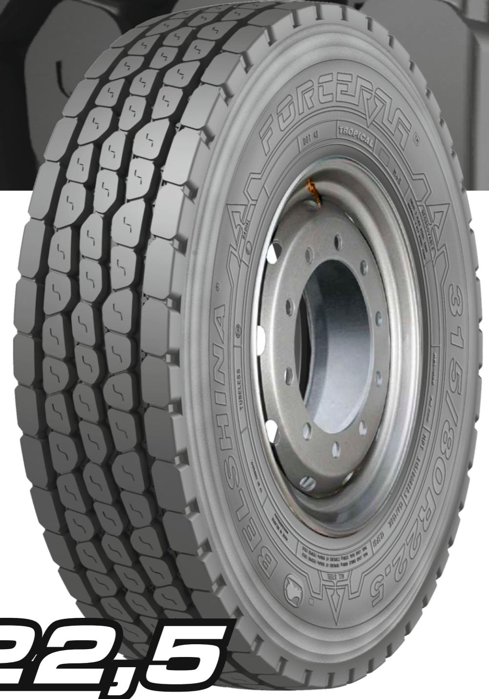
Грузовая бескамерная шина 315/80R22,5 модели **BEL-326**, радиальная, с металлокордом в каркасе и брекере, с универсальным рисунком протектора, предназначенная для эксплуатации на рулевых осях автомобилей - самосвалов, работающих на дорогах всех категорий и в условиях бездорожья для доставки грузов на строительные площадки и карьеры.
