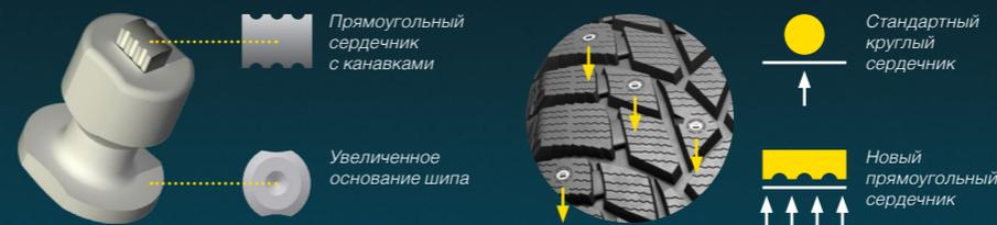
Особая форма и размер сердечника, а также большое основание шипа обеспечивают повышенную проникающую способность и стабильность рабочих характеристик при движении по льду.
