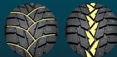
Центральная часть в виде треугольников значительно улучшает стабильность управления. Пересекающиеся канавки обеспечивают эффективный отвод воды и снежной массы из пятна контакта.
