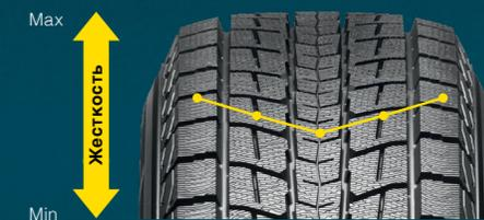
Распределение жесткости протектора стало более плавным и сбалансированным. Увеличенная жесткость в плечевой области создает предсказуемое поведение автомобиля при движении в поворотах и перестроении. Цельное центральное ребро обеспечивает стабильность движения по прямой. Данные изменения позволяют сохранить оптимальные характеристики шины при различных условиях эксплуатации.
