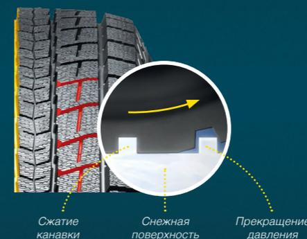
Поперечные ромбовидные канавки в сочетании с примыкающими продольными обеспечивают отличное сцепление со снегом и самоочистение протектора. Данные характеристики позволяют шине постоянно находиться в рабочем состоянии.
